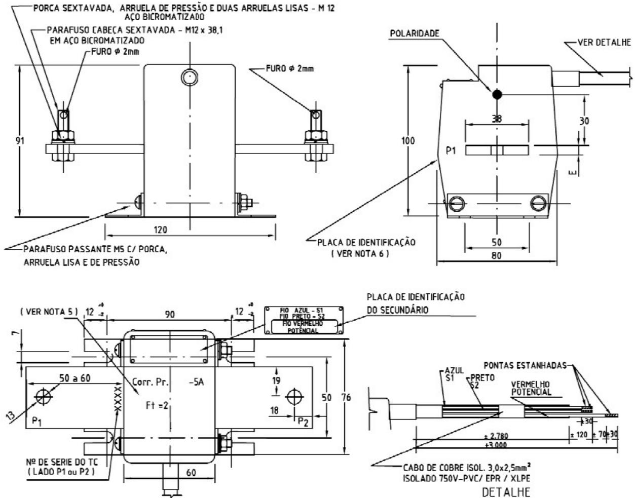
**Figura 2** - Transformador de corrente tipo barra – Tipo 2
